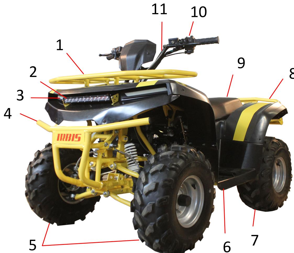
1. Передний багажник; 2. Фара головного света; 3. Габаритные огни; 4. Передний бампер; 5. Передние колеса; 6. Подножка левая;
