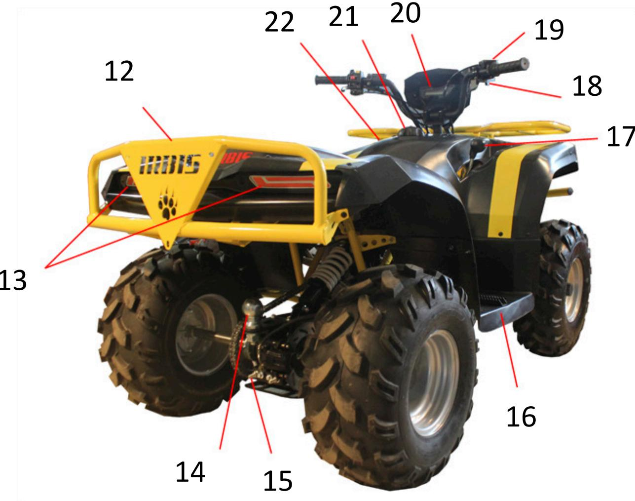
12. Место крепления номерного знака; 13. Фонари задних габаритных огней и стоп-сигнала; 14. Фаркоп; 15. Натяжитель цепи
